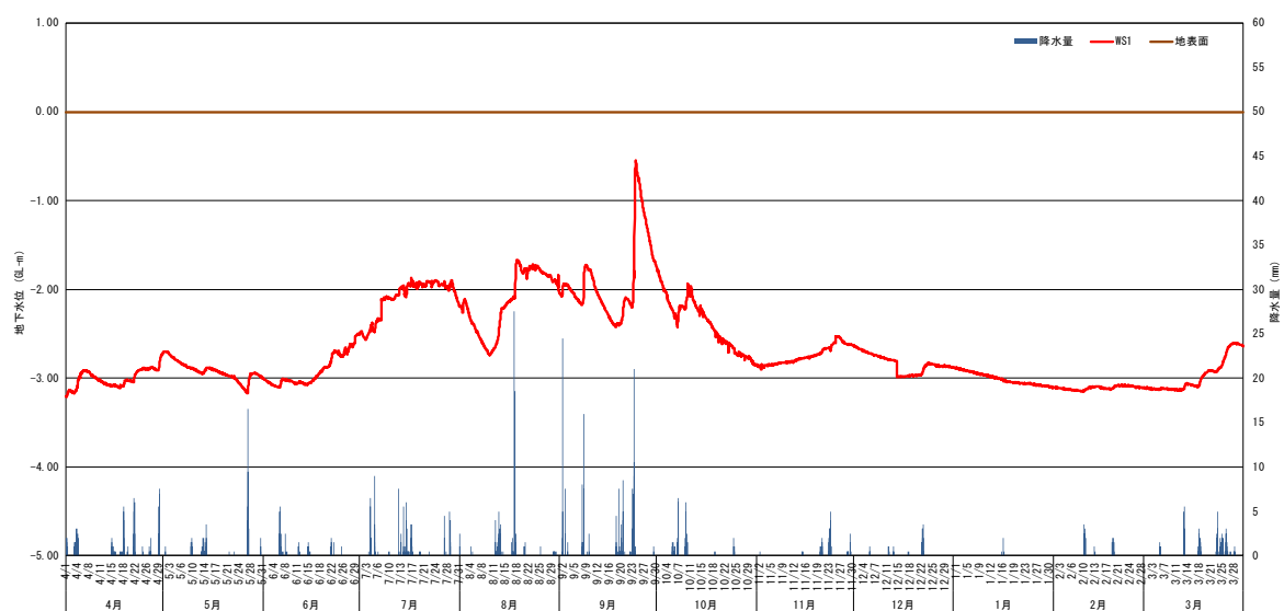
図 8.1.7-4 現地調査結果（地下水位 通年調査）
